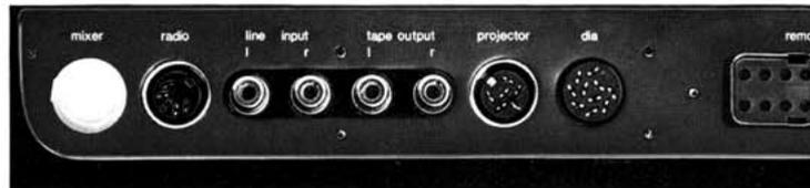
Praxisgerecht sind die Buchsen für die Dauerverbindungen, wie für Fernbedienung, Mischpult, Verstärker und andere selten wechselnde Anschlüsse, an der Rückseite des Gerätes angebracht.
